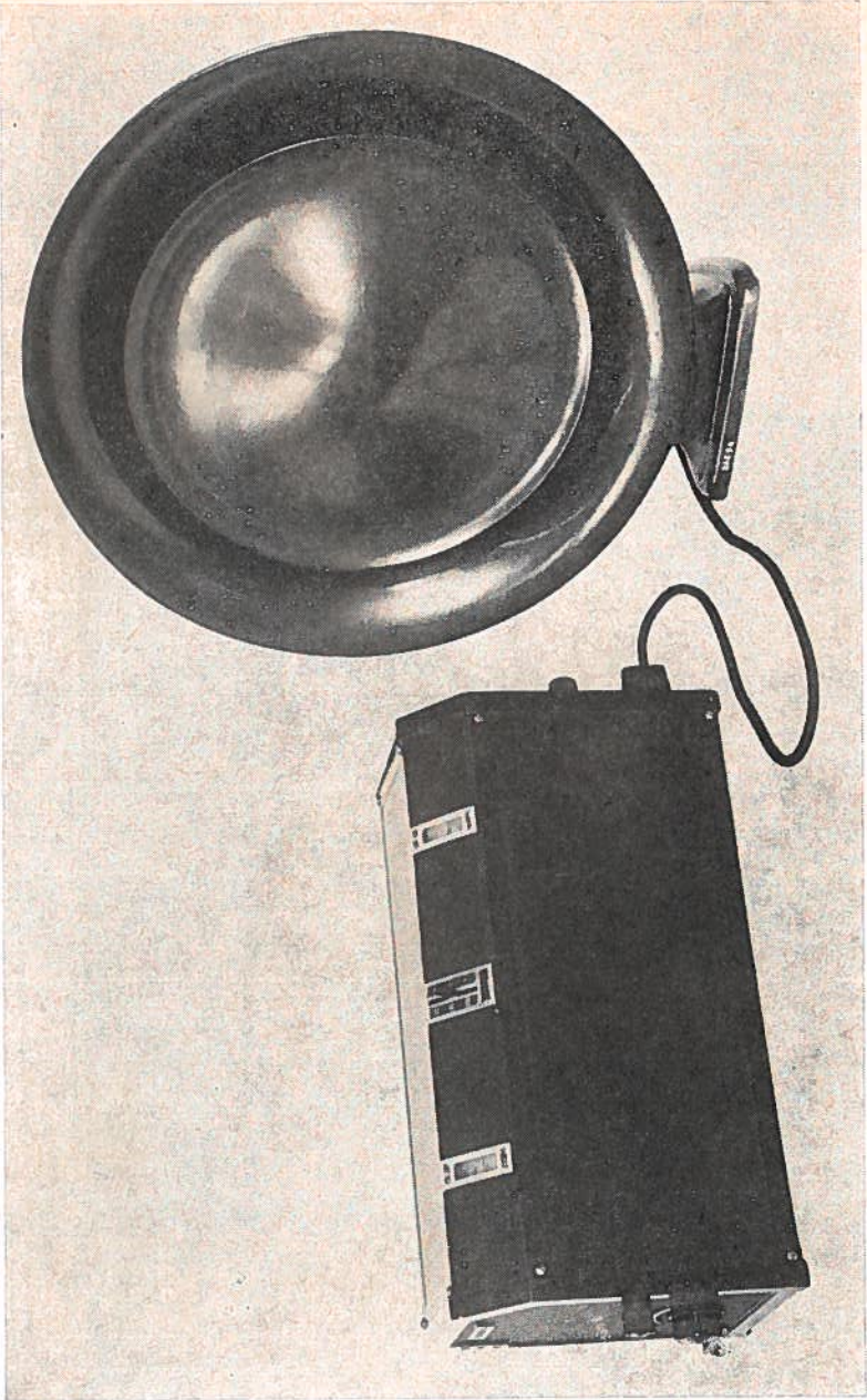
Afbeelding 33. Het door de NSF vervaardigde ontvangoestel type 2501 (1927) voorzien van 3 golfbereiken en algehele wisselstroomvoeding. Prijs f. 230.—. Op de foto tevens een der meest populaire luidsprekers uit die tijd.
